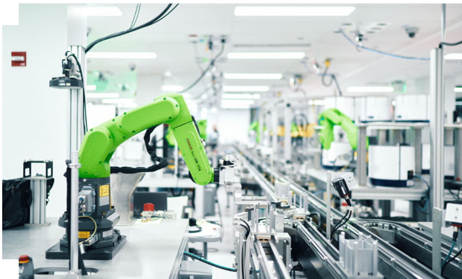
Robot per la gestione di liquidi utilizzati per automatizzare i processi di screening di campioni biologici ad alto rendimento Foto per gentile concessione di Ginkgo Bioworks
